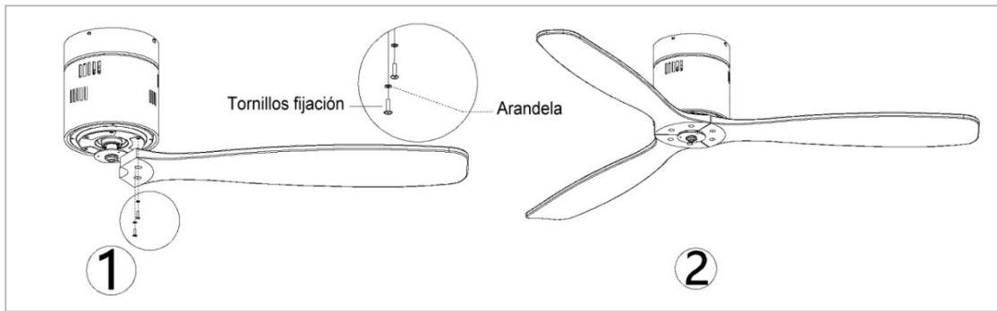
3- Montaje de la placa iluminación. Montar el plafón metálico fijándolo bajo las aspas.
