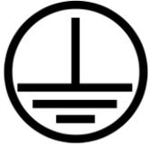
Der Erdanschluss ist als Schutzerde ausgeführt. Der LED-Treiber kann mittels Erdklemme oder über das Metallgehäuse (falls vorhanden) geerdet werden. Wird der LED-Treiber geerdet, muss dies mit Schutzerde (PE) erfolgen. Für die Funktion des LED-Treibers ist keine Erdung notwendig.
