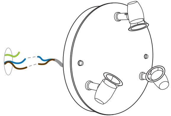
Aufgrund der Konstruktion ist der Anschluß einer Erdung (des Erdungsleiters) nicht notwendig. Die Leuchte kann verpolungssicher angeschlossen werden.
