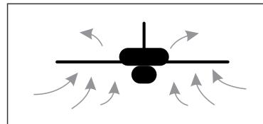
\* No usar el botón de función inversa mientras el ventilador esté en funcionamiento. El ventilador debe estar apagado y las aspas paradas.
