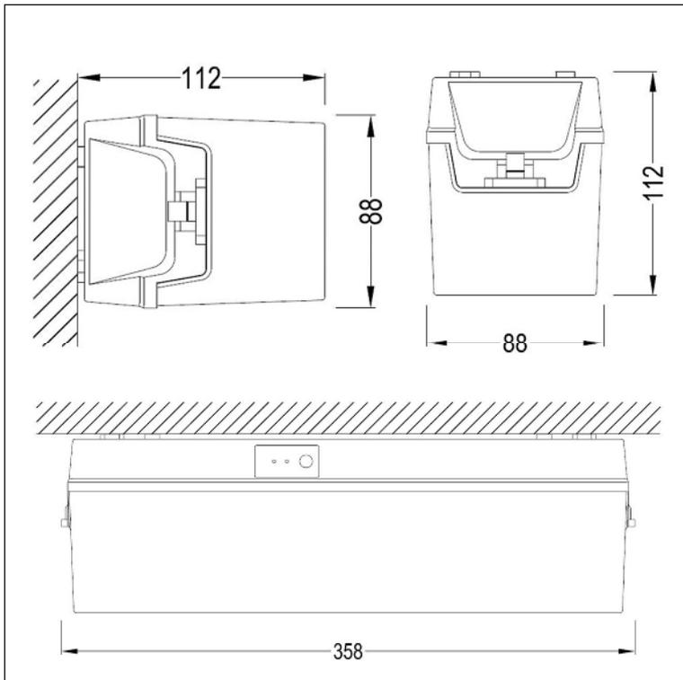
Universell einsetzbare LED-Sicherheits- und Rettungszeichenleuchte in Schutzklasse II, als Notleuchte gemäß DIN EN 60598-1, DIN EN 60598-2-22, DIN EN 62034 und DIN EN 1838 für Anlagen gemäß DIN VDE 0108 für zentrale Versorgung.
