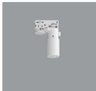
55248.000 ERCO Casambi Bewegungsmelder mit Lichtsensoren für ERCO Stromschienen 220-240V. Einrichtung über Casambi App (Android/iOS) mit Bluetooth Low Energy (BLE) fähigen Mobilgeräten. Anwendung zur tageslichtabhängigen Lichtsteuerung mit oder ohne Bewe- gungsmelder. Erfassungsbereich des Infrarot (PIR) Sensors 100°/ 5m. Bei 3m Raumhöhe ist dies ein Kreis von ca. 7m Durchmesser. 3-Phasen-Adapter für ERCO Strom- schiene 220-240V: Kunststoff, weiß. Weiß Gewicht 0,18kg RoHS CE CB
