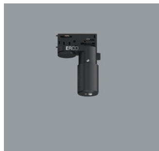
55249.000 ERCO Casambi Bewegungsmelder mit Lichtsensoren für ERCO Stromschienen 220-240V. Einrichtung über Casambi App (Android/iOS) mit Bluetooth Low Energy (BLE) fähigen Mobilgeräten. Anwendung zur tageslichtabhängigen Lichtsteuerung mit oder ohne Bewe- gungsmelder. Erfassungsbereich des Infrarot (PIR) Sensors 100°/ 5m. Bei 3m Raumhöhe ist dies ein Kreis von ca. 7m Durchmesser. 3-Phasen-Adapter für ERCO Strom- schiene 220-240V: Kunststoff, schwarz. Schwarz Gewicht 0,18kg RoHS CE CB
