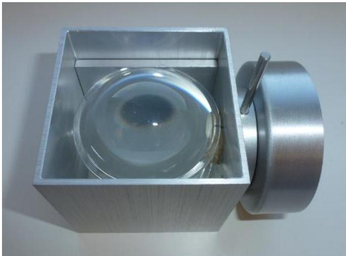
Justierstab entfernen und Madenschrauben mit dem mitgelieferten Inbus entfernen:
