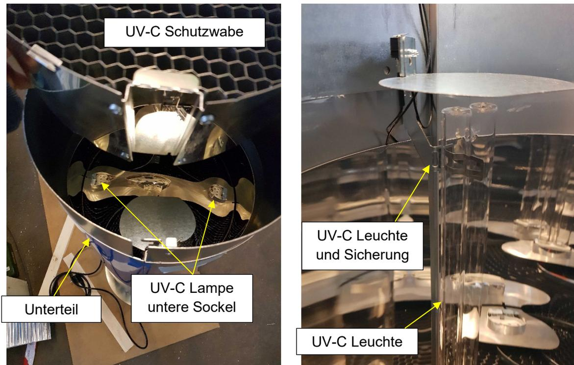
Abbildung 6: Montageschritt 2 - Installation der UV-C Leuchten
