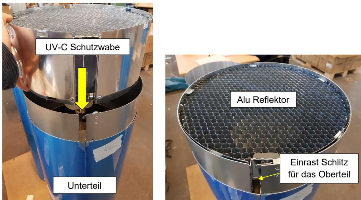
Abbildung 7: Montageschritt 3 – Installation der Aluminium Reflektor
