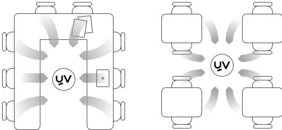
Abbildung 5: Optimale Position des youvee® Luftreinigers
