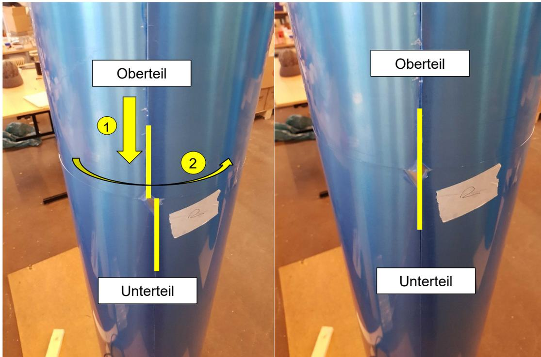
Abbildung 8: Montageschritt 4 – Installation und Verriegelung des Oberteils
