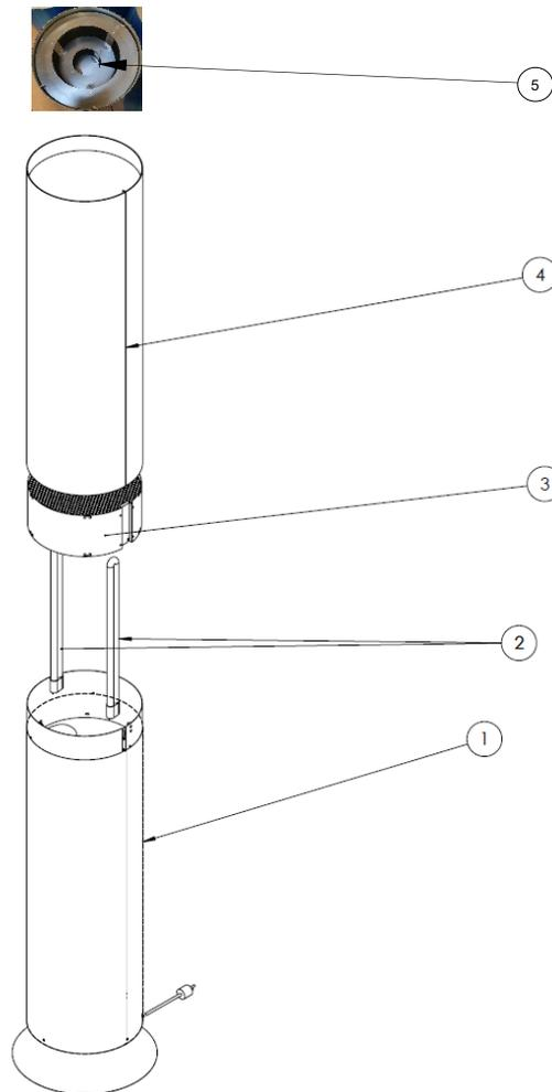
Abbildung 1: Lieferumfang eines Youvee Luftreiniger
