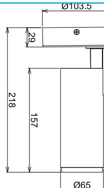
Die dreh- und schwenkbaren Deckenleuchten der LUCEA-Serie sind in den Leistungsstufen 6, 10, 15, 20 und 30 Watt erhältlich. Mit einem Drehwinkel von 350° und einem Schwenkwinkel von 90° können die Leuchten individuell auf Kundenwünsche eingestellt werden. Sie bieten je nach Ausführung bis zu 2.900 Lumen Lichtleistung. Durch den Tausch von optional erhältlichen Linsen, lässt sich der Abstrahlwinkel verengen oder erweitern.
