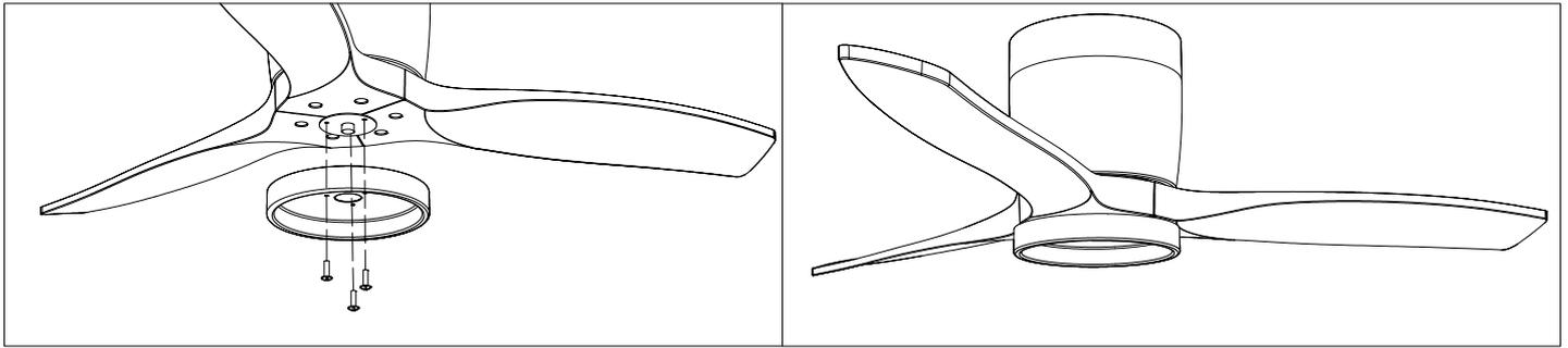
DE: Dévisser une vis d'assemblage. Fixez le panneau LED au bas du ventilateur en insérant les deux autres têtes de vis dans les fentes des trous de serrure, faites-le tourner pour le mettre en place, puis fixez la vis précédente en alignant le trou de la vis et le trou au bas du ventilateur, serrez les deux autres vis pour fixer le panneau LED.
