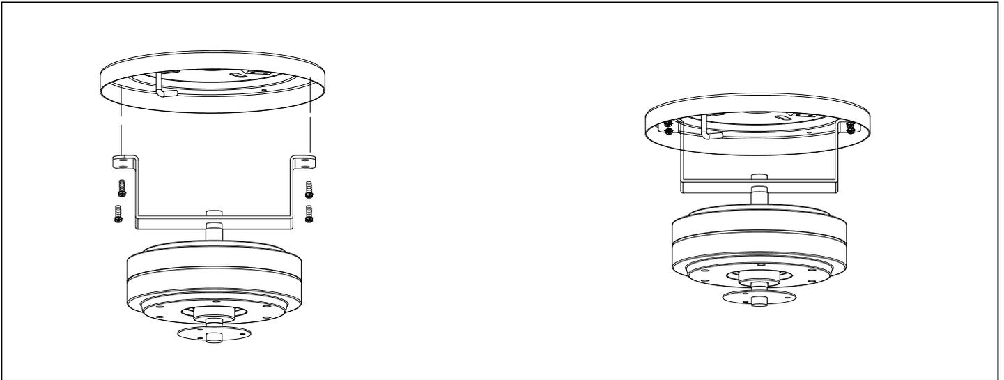
DE: Richten Sie die Halterung auf das Schraubenloch der Aufhängeplatte aus, und ziehen Sie alle Schrauben nach dem Anschließen fest. Wiederholen Sie diesen Vorgang für die übrigen Klingenarme, bevor Sie die Schrauben endgültig befestigen.
