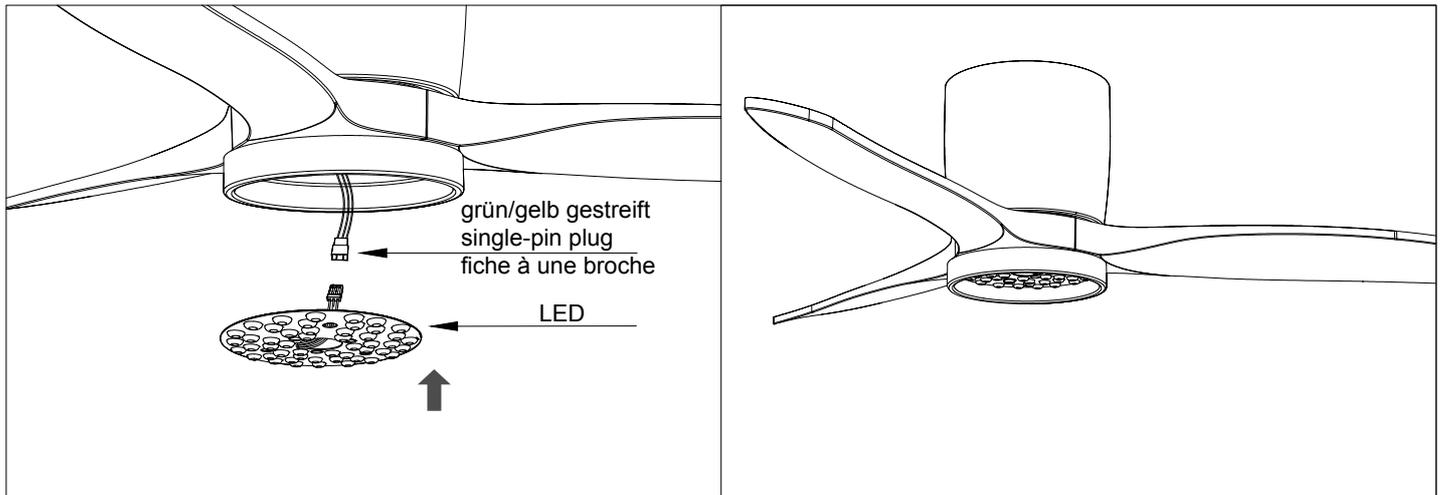
DE: Setzen Sie die Abdeckung und den Lampenschirm wieder in die LED-Schale ein.
