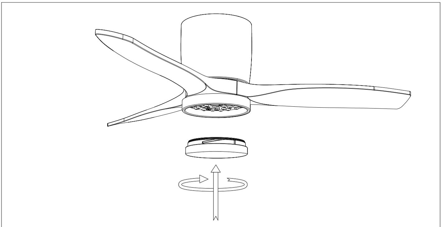
DE: Bringen Sie die Abdeckung und den Lampenschirm wieder an der LED-Schale an und befestigen Sie sie mit Zierklammern und Schraubenmutter.
