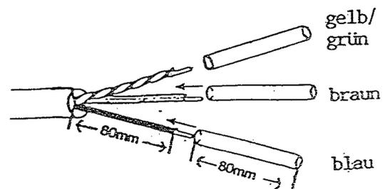
Schakel de electriciteit tijdelijk uit alvorens het toestel te plaatsen. De siliconenkousen over de netaansluitdraden schuiven. De fabrikant aanvaardt geen enkele aansprakelijkheid voor letsel of schade als gevolg van een verkeerde toepassing van het verlichtingsarmatuur! Raadpleeg een vakman ingeval van twijfel. Bewaar deze gebruiksaanwijzing.
