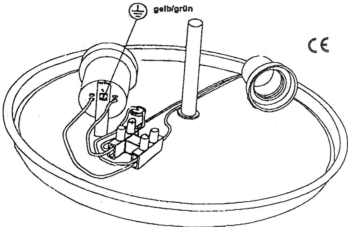
Netzleitungen vollständig mit Wärmeschutzschlauch überziehen
