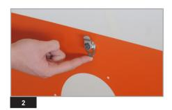
2) zur montage des schlosses stecken sie es in das vorgesehene loch in der klappe, prüfen sie ob der riegel beim schließen nach oben zeigt, das schloss wird mit der gabelförmigen montagezunge von innen durch aufschieben der zunge befestigt.
