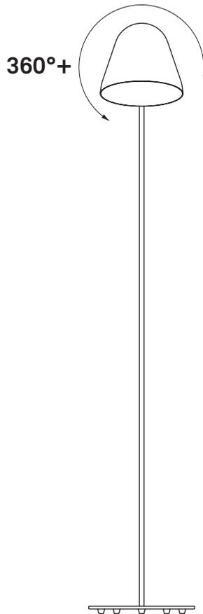
Der Leuchtschirm kann um eine Achse frei gedreht werden.
