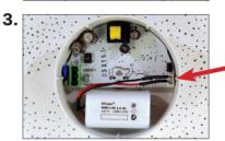
Akku anschließen (nur bei Einzelbatterieleuchten). Deckel auf das montierte Leuchtenunterteil drücken.
