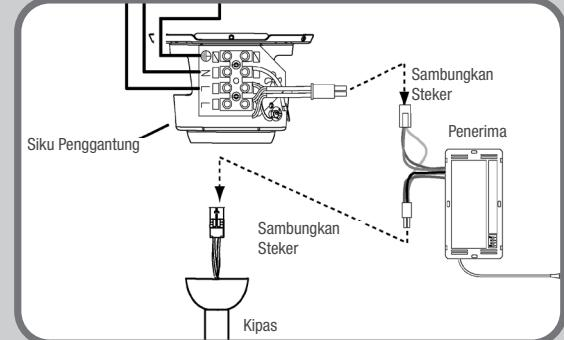
Lakukan penyambungan kabel dengan menggunakan steker 4-pin yang datang dari penerima, kipas, dan siku penggantung seperti yang diperlihatkan. Hubungkan steker betina dari penerima ke steker jantan dari siku penggantung. Hubungkan steker jantan dari penerima ke steker betina dari kipas.
