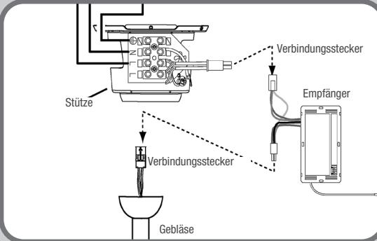
Stellen Sie die Verbindungen zwischen den 4-Pin-Steckern vom Empfänger, dem Gebläse und der Stütze her wie dargestellt. Verbinden Sie den Stecker vom Empfänger mit der Buchse von der Stütze. Verbinden Sie die Buchse vom Empfänger mit dem Stecker vom Gebläse.
