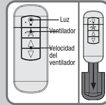
Presione y libere rápidamente el botón del ventilador en el control remoto para apagar o encender el ventilador. Use la almohadilla direccional del control remoto para elevar o bajar el ventilador a la velocidad deseada.
