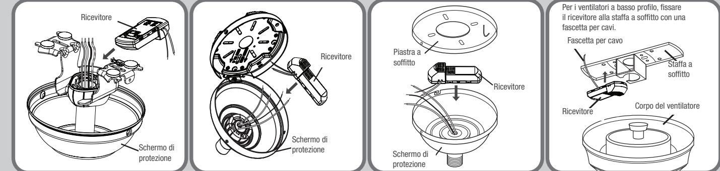
**Scegliere il sistema di sospensione che più si avvicina a quello utilizzato dal ventilatore e posizionare il ricevitore come mostrato in figura.**
