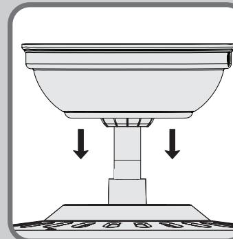
Retirez la monture. En cas de doute sur la manière de l'enlever, reportez-vous au manuel d'utilisation du ventilateur. Assurez-vous que tout le câblage est réalisé conformément au manuel d'utilisation du ventilateur avant d'installer le récepteur.
