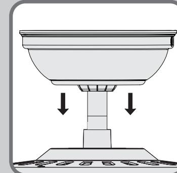
Retire la campana. Si no está seguro de cómo quitarla, consulte el manual del propietario del ventilador. Asegúrese de que todas las conexiones de los cables sean realizadas conforme al manual del Propietario del ventilador antes de instalar el receptor.
