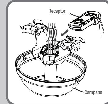
Elija el sistema de suspensión que más se parezca al que utiliza su ventilador y coloque el receptor según se muestra.
