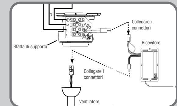
Collegare i fili usando i connettori a 4 pin provenienti dal ricevitore, ventilatore e staffa di supporto come mostrato. Collegare il filo femmina dal ricevitore al connettore maschio dalla staffa di supporto. Collegare il filo maschio dal ricevitore al connettore femmina dal ventilatore.
