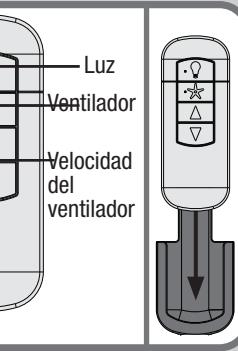
Presione y libere rápidamente el botón del ventilador en el control remoto para apagar o encender el ventilador. Use la almohadilla direccional del control remoto para elevar o bajar el ventilador a la velocidad deseada.
