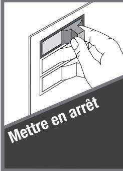
Avant d'installer le récepteur de la télécommande universelle, utilisez les tirettes pour régler la vitesse du ventilateur sur « Rapide » et la lumière sur « Marche ». Assurez-vous que le courant est bien coupé avant de procéder à l'installation.
