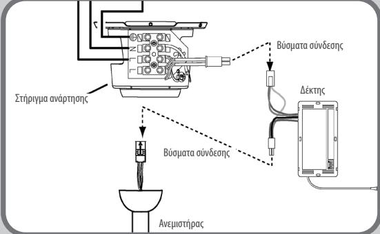
Πριν εγκαταστήσετε το δέκτη του τηλεχειριστήριου γενικά χρήστε, χρησιμοποιήστε τους διακόπτες-αλυσίδα, για να ρυθμίσετε την ταχύτητα του ανεμιστήρα σε υψηλή και να ενεργοποιήστε το φωτισμό. Βεβαιωθείτε ότι η πληκτρολογία έχει διακοπεί, πριν συνέχιστε με την εγκατάσταση.
