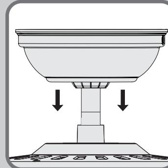
Bevor Sie den Universal-Fernbedienungsempfänger installieren, stellen Sie die Gebläsegeschwindigkeit mit der Zugkette auf HOCH und schalten Sie das Licht EIN. Stellen Sie sicher, dass die Stromzufuhr AUS ist, bevor Sie mit der Montage fortfahren.
