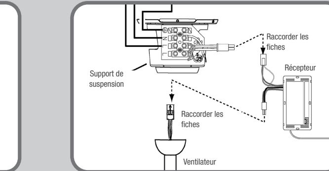
Réalisez le câblage en utilisant les fiches à 4 broches provenant du récepteur, du ventilateur et du support de suspension comme indiqué. Branchez la prise femelle du récepteur à la prise mâle du support de suspension. Branchez la prise mâle du récepteur à la prise femelle du ventilateur.
