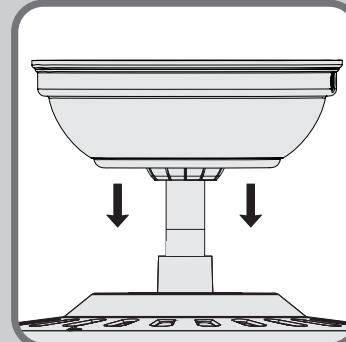
Antes de instalar o receptor do comando universal, utilize as correntes de tração para definir a velocidade do ventilador para ALTA e a luz para LIGADO. Certifique-se de que a energia está desligada antes de prosseguir com a instalação.
