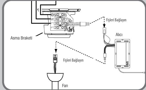
Gösterildiği şekilde alıcıdan, fandan ve asma braketinden gelen 4 pinli fisiler kullanarak kablo bağlantılarını yapın. Alıcıdan gelen dişi fisi asma braketinden gelen erkek fisine takın. Alıcıdan gelen erkek fisini fandan gelen dişi fisine takın.
