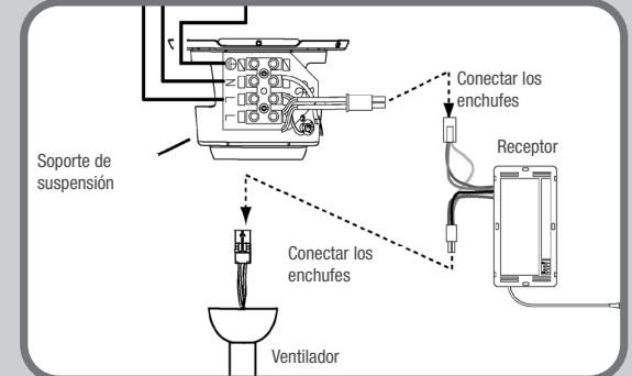
Realice las conexiones de los cables usando los enchufes de 4 terminales que vienen del receptor, el ventilador y el soporte colgante, conforme se muestra. Conecte el enchufe hembra desde el receptor con el enchufe macho del soporte colgante. Conecte el enchufe macho desde el receptor con el enchufe hembra del ventilador.
