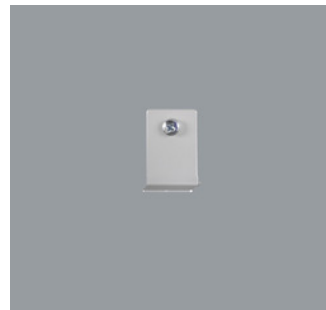
79500.000 Abhängung für Stromschiene­n Metall, verzinkt. Die Abhängung kann nachträglich von oben in die ERCO Stromschiene eingesetzt werden. Belastung 15kg. L 30mm, H 47mm.
