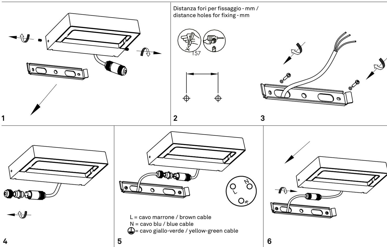
1) Rimuovere la staffa di fissaggio a muro. 2-3) Forare il muro e inserire i tasselli in plastica ad espansione. Fissare la staffa alla parete. 4) Svitare il connettore impermeabile. 5) Collegare al morsetto i cavi di alimentazione seguendo lo schema indicato. 6) Riavvitare il connettore impermeabile con molta cura. Fissare la lampada alla staffa facendo attenzione che tutti i cavi e le guarnizioni rimangano all'interno della base nelle loro sedi.
