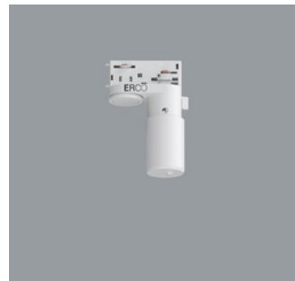
55248.000 ERCO Casambi Bewegungsmelder mit Lichtsensor für ERCO Stromschienen 220-240V. Einrichtung über Casambi App (Android/iOS) mit Bluetooth Low Energy (BLE) fähigen Mobilgeräten. Anwendung zur tageslichtabhängigen Lichtsteuerung mit oder ohne Bewe- gungsmelder. Erfassungsbereich des Infrarot (PIR) Sensors 100°/ 5m. Bei 3m Raumhöhe ist dies ein Kreis von ca. 7m Durchmesser. 3-Phasen-Adapter für ERCO Strom- schiene 220-240V: Kunststoff, weiß. Weiß Gewicht 0,18kg RoHS CE CB
