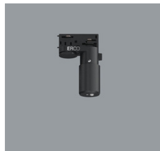
55249.000 ERCO Casambi Bewegungsmelder mit Lichtsensor für ERCO Stromschienen 220-240V. Einrichtung über Casambi App (Android/iOS) mit Bluetooth Low Energy (BLE) fähigen Mobilgeräten. Anwendung zur tageslichtabhängigen Lichtsteuerung mit oder ohne Bewe- gungsmelder. Erfassungsbereich des Infrarot (PIR) Sensors 100°/ 5m. Bei 3m Raumhöhe ist dies ein Kreis von ca. 7m Durchmesser. 3-Phasen-Adapter für ERCO Strom- schiene 220-240V: Kunststoff, schwarz. Schwarz Gewicht 0,18kg RoHS CE CB
