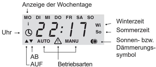
Die Modi Gurtkastenuhr dient zum elektrischen Anschluss und zur Steuerung von Rohrmotoren und kann in vorhandene Gurtkästen montiert werden.
