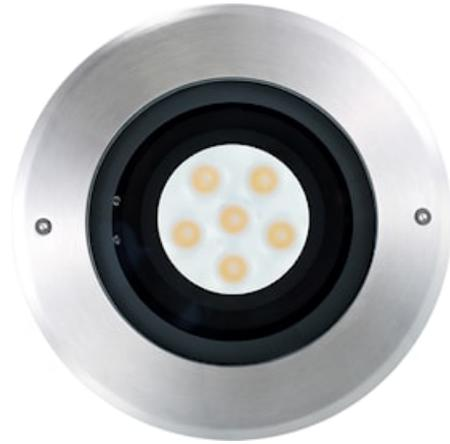
Runde Bodeneinbauleuchte mit +/-30° verstellbarem Lichtmodul, überfahrbar für Druckbelastungen bis 2000kg (20kN), mit 2m 3x1 mm<sup>2</sup> Flugkabel und Einbaurohr, Aluminiumgehäuse mit Zierring aus Edelstahl (SS316) und Klarglasdiffusor, IP67, IK10, Klasse I, nicht dimmbar, 1025 lm, 13,5 W, 76 lm/W, CRI80, 30° Abstrahlwinkel, 50.000 Stunden L70:B50 Lumenerhalt, 200 mm Durchmesser, 229 mm Einbaurohrhöhe, 2,3kg Gewicht.
