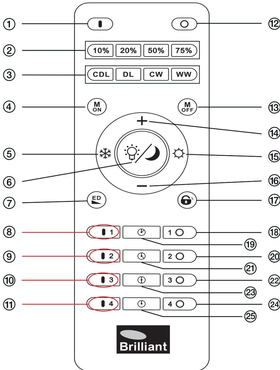
**DE Schnellstart:** Halten Sie eine dieser Tasten gedrückt, während Sie die Lampe zum ersten Mal einschalten, um die Fernbedienung mit der Lampe zu verbinden.
