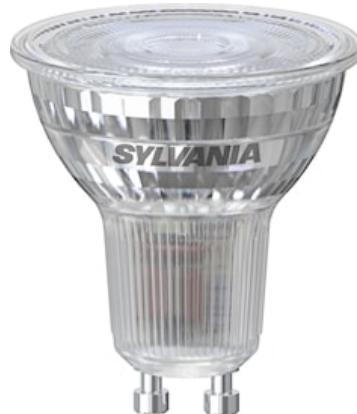
Professionelle LED-GU10-Serie mit Premium-Leistung und dem gleichen Aussehen und Gefühl wie herkömmliche Halogen-GU10-Lampen. Erzeugt einen Rücklichteffekt ähnlich wie bei halogenen Dichroic-Lampen. Vollglasdesign – verhindert Farbkonflikte zwischen Lampe und Leuchte. Sehr lange Lebensdauer von bis zu 25.000 Stunden. COOLFIT-Funktionalität – sorgt für Überhitzungs- und Übertemperaturschutz. Hohe Schaltzyklen: >100.000. Hohe Farbwiedergabe: CRI90. Dimmbar. Garantie: 5 Jahre.
