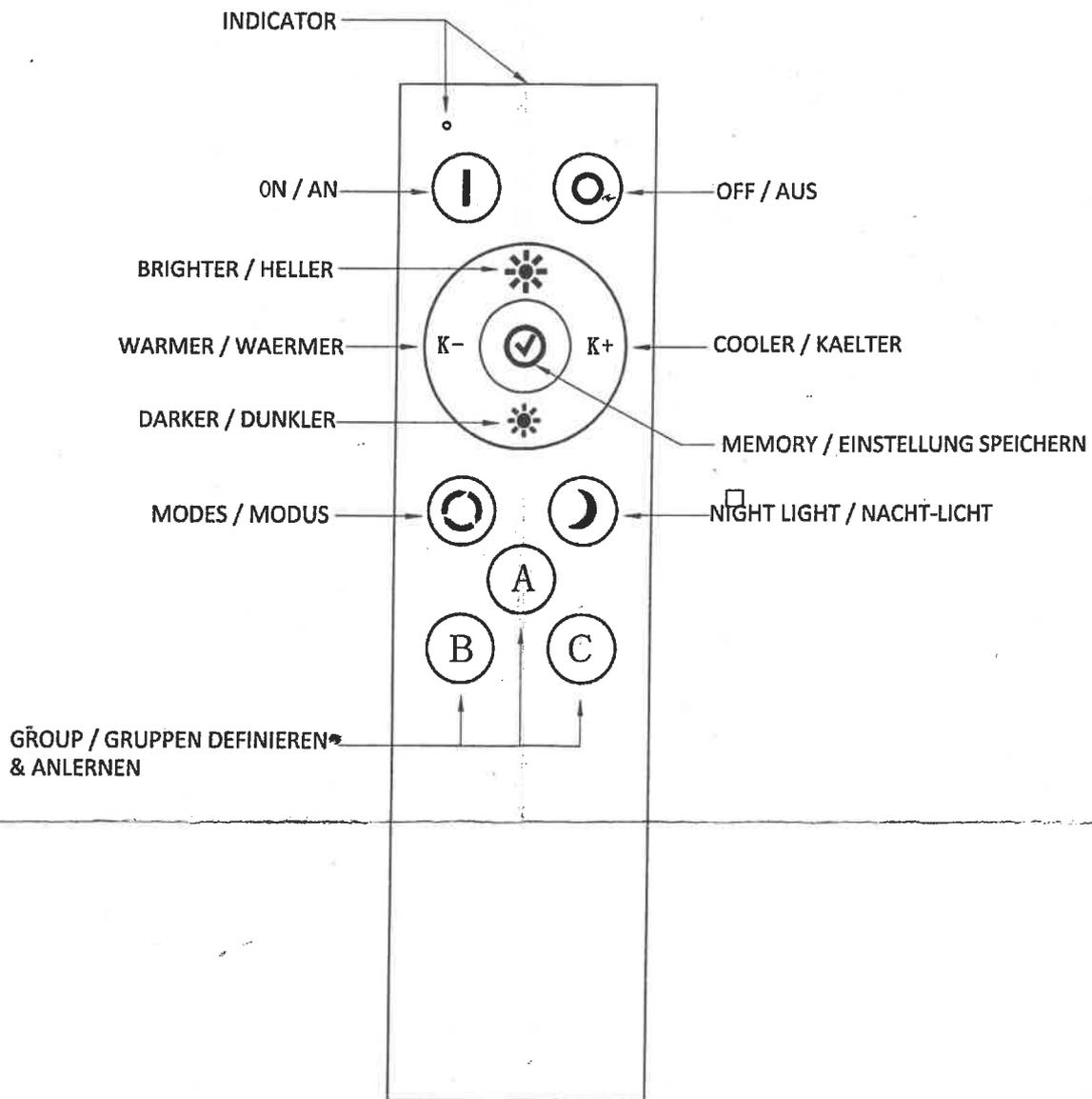
**Pairing procedure: Verbinden der Leuchte mit der Fernbedienung & Gruppen bilden**
