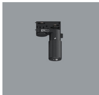
55249.000 ERCO Casambi Bewegungsmelder mit Lichtsensor für ERCO Stromschienen 220-240V. Einrichtung über Casambi App (Android/iOS) mit Bluetooth Low Energy (BLE) fähigen Mobilgeräten. Anwendung zur tageslichtabhängigen Lichtsteuerung mit oder ohne Bewe- gungsmelder. Erfassungsbereich des Infrarot (PIR) Sensors 100°/ 5m. Bei 3m Raumhöhe ist dies ein Kreis von ca. 7m Durchmesser. 3-Phasen-Adapter für ERCO Strom- schiene 220-240V: Kunststoff, schwarz. Schwarz Gewicht 0,18kg CE RoHS
