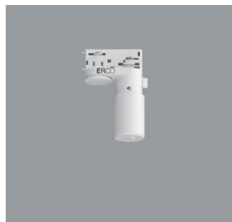
55248.000 ERCO Casambi Bewegungsmelder mit Lichtsensor für ERCO Stromschienen 220-240V. Einrichtung über Casambi App (Android/iOS) mit Bluetooth Low Energy (BLE) fähigen Mobilgeräten. Anwendung zur tageslichtabhängigen Lichtsteuerung mit oder ohne Bewe- gungsmelder. Erfassungsbereich des Infrarot (PIR) Sensors 100°/ 5m. Bei 3m Raumhöhe ist dies ein Kreis von ca. 7m Durchmesser. 3-Phasen-Adapter für ERCO Strom- schiene 220-240V: Kunststoff, weiß. Weiß Gewicht 0,18kg CE RoHS
