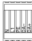
**DE** Anschlussschema für PhasenDim-Betrieb
