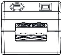
Sekundäre Zugentlastung für Kabel mit kleinerem Kabelmantel
