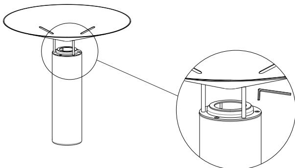
5. Conecte los cables y fijelo, teniendo en cuenta la altura final deseada. Coloque la lámpara sobre la placa (F) y apriete los espárragos (G) para sujetarla.
