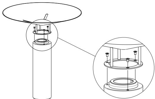
4. Aflojar los espárragos (A) para liberar la placa trasera (B). Pasar cable eléctrico por el agujero de la tapa posterior (A) y fijar al techo con los tornillos.
