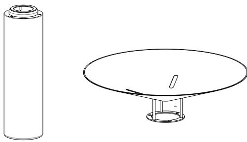
3. Una vez la pantalla esté colocada en la base, aprete los tornillos. Apriete poco a poco cada tornillo hasta llegar a tener la pantalla bien sujetada
