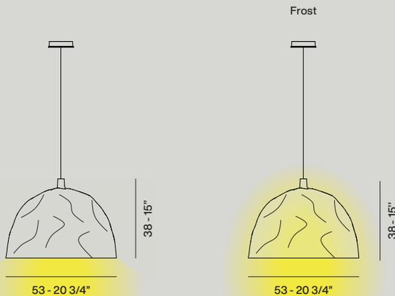
PMMA oder ABS-Kunststoff, spritzgegossen und flüssiglackiert
