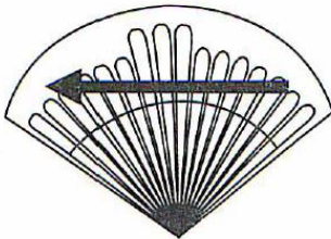
Draufsicht: Erfassungswinkel 180°, Reichweite 5-8 Meter
