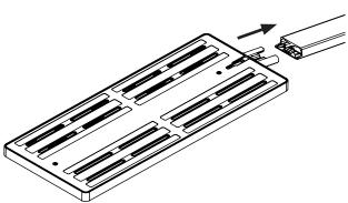
Leuchtenkopf langsam bis zum Anschlag in das Leuchtenrohr einschieben, dadurch werden automatisch alle elektrischen Verbindungen hergestellt.
