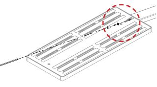
Der Leuchtenkopf wird über eine Innensechskantmutter mit Zahnscheibe gesichert. Schraube nur leicht anziehen!
