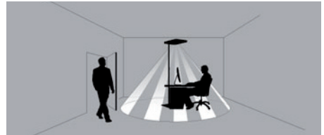
Fig. 8: Erfassungsbereich PIR Sensor.
