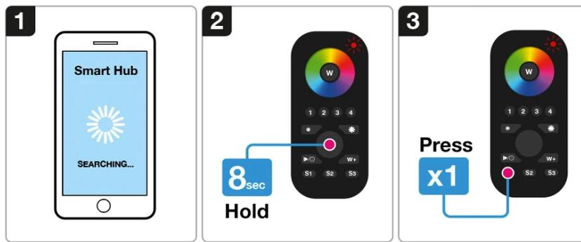
1. Wählen Sie, dass Sie ein neues Gerät von Ihrer kompatiblen Zigbee-Hub-Schnittstelle hinzufügen möchten, und beginnen Sie mit der Suche nach neuen Zigbee-Geräten im Netzwerk.
