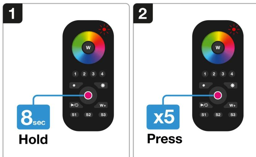
1. Halten Sie die Ein/Aus-Taste der Fernbedienung gedrückt, bis die rote LED-Anzeige dauerhaft rot leuchtet.
