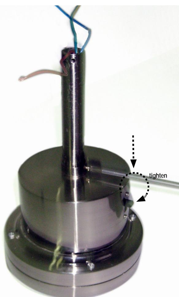
**ESP** Coloque el pasador y la horquilla. Apriete el tornillo que sujeta el pasador.
