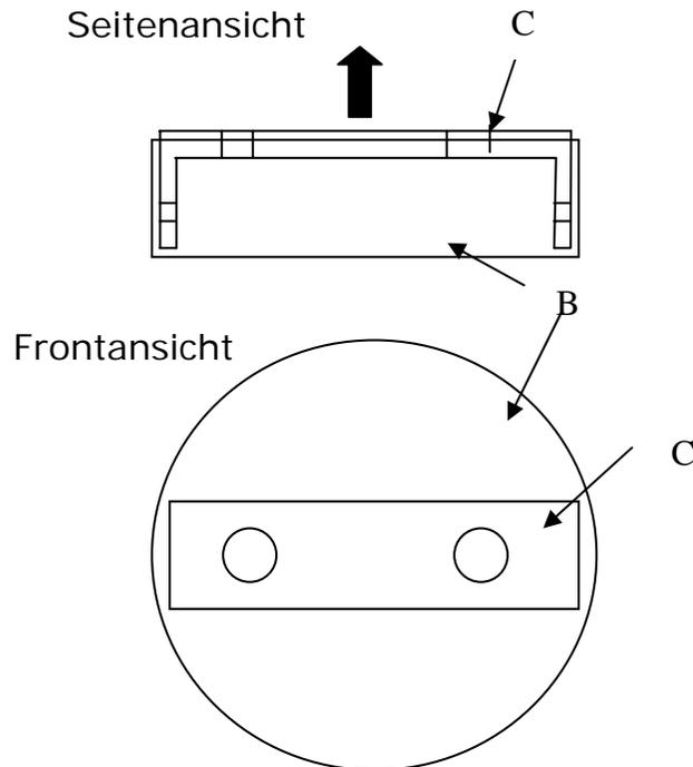
2. Entnehmen Sie nun den Wandhaltebügel (C) aus dem Installationsgehäuse (B).
