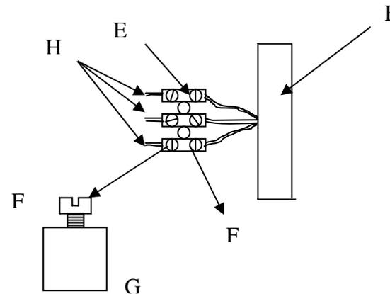
4. Entnehmen Sie nun die Lüsterklemme (E) aus dem Installationsgehäuse (B).
