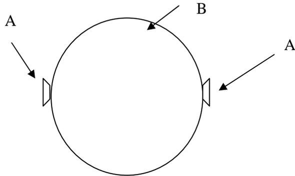
1. Entfernen Sie die Schrauben (A) auf der linken und rechten Seite des Installationsgehäuses (B), indem Sie diese mit einem Schraubendreher gegen den Uhrzeigersinn herausschrauben.
