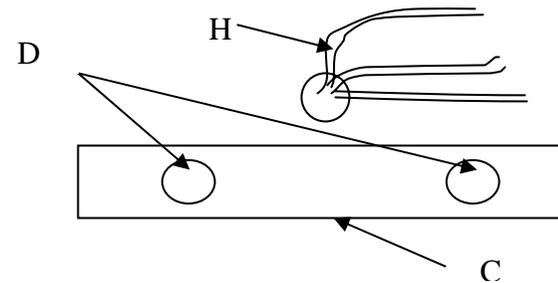
3. Positionieren Sie den Haltebügel (C) an der Wand (unterhalb der aus der Wand kommenden Elektroanschlusskabel (H)) und verschrauben Sie diesen. Die Löcher des Haltebügels geben die Stelle vor, an welche die Schrauben anzusetzen sind (D).
