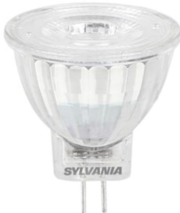
LED-MR11-Serie mit dem gleichen Look and Feel wie eine traditionelle Halogen-MR11-Lampe. Vollglasdesign – verhindert Farbkonflikte zwischen Lampe und Leuchte. Verfügbar mit 36° Abstrahlwinkel. Durchschnittliche Nennlebensdauer: 15.000 Stunden. Schaltzyklen: 50.000. Farbwiedergabe: CRI80. Lampenspannung: 12 V AC/DC. Funktioniert mit magnetischen und kompatiblen elektronischen Transformatoren\*. Garantie: 3 Jahre.
