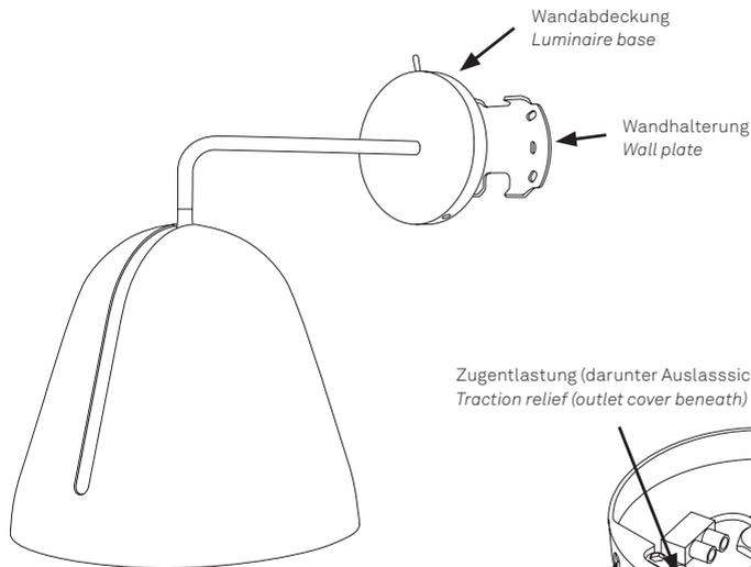
Zugentlastung (darunter Auslasssicherung)
