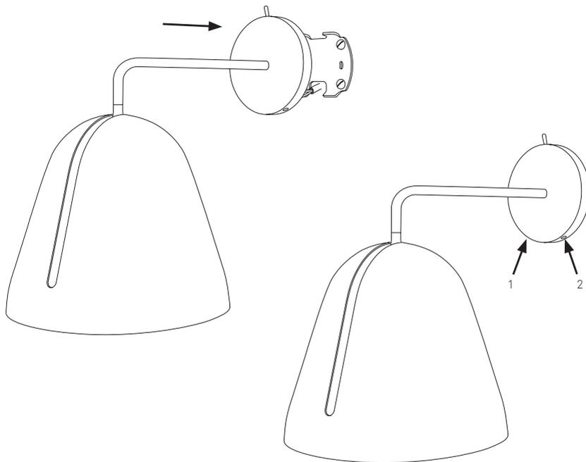
Leuchte auf die Wandhalterung aufsetzen. Dabei darauf achten, dass keine Kabel eingeklemmt werden.
