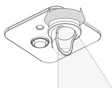
Vous pouvez limiter la zone de détection du détecteur de mouvement par un cache. Vous pouvez régler la zone de détection en tournant le cache.
