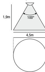
Die Messung kann durch dunkle Oberflächen (zB Boden, Schreibtisch, usw) beeinflusst werden.
