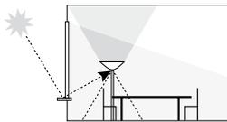
2. Den Sensor nicht direktem Sonnenlicht aussetzen. Im Fensterbereich sollte die Platzierung so gewählt werden, dass der gesamte Erfassungsbereich innerhalb des Raumes liegt und Reflektionen des Tageslichtes durch spiegelnde Oberflächen nicht in den Sensor fallen. Hinweis: Reflexionen an Glas oder Metalloberflächen können den Sensor blenden und somit die Lichtsteuerung beeinträchtigen. Das Versetzen des Sensors ist unbedingt notwendig.
