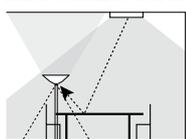
1. Non esporre il sensore a luce diretta. La luce riflessa sul luogo di lavoro viene rilevata dai sensori di luce ambiente. Per questo bisogna evitare di posizionare il sensore in un luogo dove c'è il rischio che questi venga irradiato da una fonte di luce diretta.
