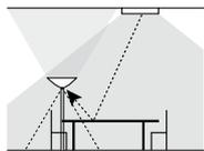
1. Den Sensor nicht direktem Licht aussetzen. Das reflektierte Licht am Arbeitsplatz, wird von den Umgebungslichtsensoren gemessen, daher ist es zu vermeiden den Sensor so zu platzieren, dass dieser von einer Lichtquelle direkt angestrahlt wird.
