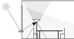
2. N'exposez pas le capteur à la lumière directe du soleil. Si vous placez le capteur près d'une fenêtre, la zone de détection doit rester à l'intérieur de la pièce et doit être protégée de la lumière du jour par des surfaces réfléchissantes. Indication : la réflexion de la lumière, sur du verre ou une surface métallique, peut éblouir le capteur et altérer la commande de la lumière. Il est impératif de déplacer le capteur.
