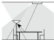
1. N'exposez pas le capteur à la lumière indirecte. La lumière réfléctée sur le lieu de travail est mesurée par les capteurs de lumière ambiante, le capteur doit donc être placé de sorte qu'il ne soit pas illuminé par une source de lumière.
