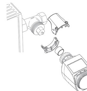
**i** De iets langere bovenschaal moet verhinderen dat de radiatorthermostaat wordt afgedraaid. Hij is zo lang, dat hij bij het draaien van de aansluiting tegen het ventiel stoot. De uitlijning van de bovenschaal is afhankelijk van de positie van de buisuitgangen van het ventiel. Bij de uitlijning dient ervoor te worden gezorgd dat er voldoende ruimte vrij blijft om de schroeven in de diefstalbeveiling te steken. De moeren kunnen zowel in de lange bovenschaal als in de onderschaal worden gelegd.
