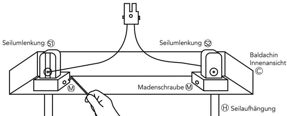
Aufgrund der Natürlichkeit des Materials Holz und seiner eigenen Holzdichte variiert das Eigengewicht eines jeden HerzBlut-Leuchtenkörpers ①. Die Gegengewichte ② sind auf ein Durchschnittsgewicht abgestimmt. Wenn der Leuchtenkörper ① schwerer als sein Gegengewicht ist, muss die „zusätzliche Last“ aufgefangen werden.
