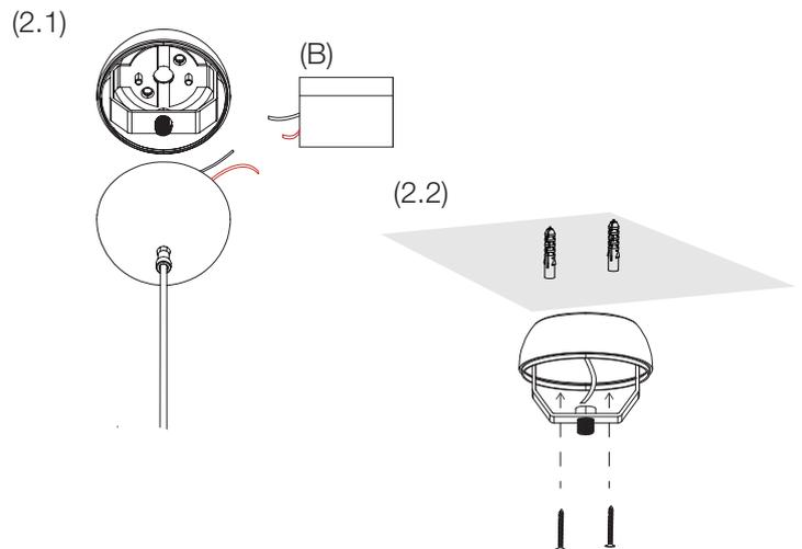
3. Fijar la altura deseada apretando el frenacables y cortar el cable sobrante. Volver a hacer las conexiones manteniendo las polaridades.
