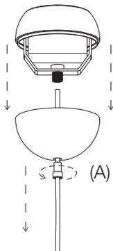
2. Desconectar el driver (B) y aflojar el frenacables (2.1) para separar la contratapa y fijarla al techo (2.2)
