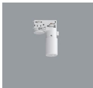
55248.000 ERCO Casambi Bewegungsmelder mit Lichtsensor für ERCO Stromschienen 220-240V. Einrichtung über Casambi App (Android/iOS) mit Bluetooth Low Energy (BLE) fähigen Mobilgeräten. Anwendung zur tageslichtabhängigen Lichtsteuerung mit oder ohne Bewe- gungsmelder. Erfassungsbereich des Infrarot (PIR) Sensors 100°/ 5m. Bei 3m Raumhöhe ist dies ein Kreis von ca. 7m Durchmesser. 3-Phasen-Adapter für ERCO Strom- schiene 220-240V: Kunststoff, weiß. Weiß Gewicht 0,18kg
