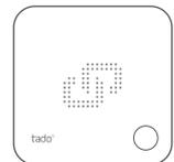
Falls das Pairing fehlschlägt (E0), stelle sicher, dass der Abstand zwischen den Geräten ca. 3 Meter beträgt. Führe das Pairing erneut durch, indem du die Taste 3 Sek lang drückst.
