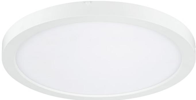
START Downlight 5in1 ist eine integrierte LED-Einbau-/Aufbauleuchte mit eingebautem dimmbarem Treiber. Die Farbtemperatur (3000K, 4000K und 6500K) kann über einen 3-Wege-Schalter auf der Rückseite der Leuchte eingestellt werden. Anpassbar an verschiedene Ausschnitte von 65 mm bis 260 mm.
