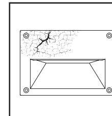
**ITA.** Durante il montaggio e la manutenzione degli apparecchi è necessario prestare particolare attenzione a non danneggiare la verniciatura a polvere. Un danno combinato all'azione dell'acqua potrebbe provocare la corrosione.
