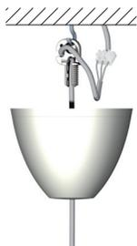
Bringen Sie den Deckenhaken an der Decke an. Hängen Sie dann den Aufhänger in den Deckenhaken ein und schließen Sie das Kabel an die Stromversorgung an. **Die Unterkante des Deckenhakens sollte min. 28 und max. 38 mm von der Decke entfernt sein. Wenn der Ring (siehe rechts) aufgelegt ist, min. 36 und max. 46 mm.**
