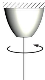
Schrauben Sie danach das Baldachingehäuse auf den Aufhänger bis es plan an der Decke sitzt. Ziehen Sie dabei leicht am Kabel, so dass sich der Aufhänger im Inneren gerade ausrichtet.
