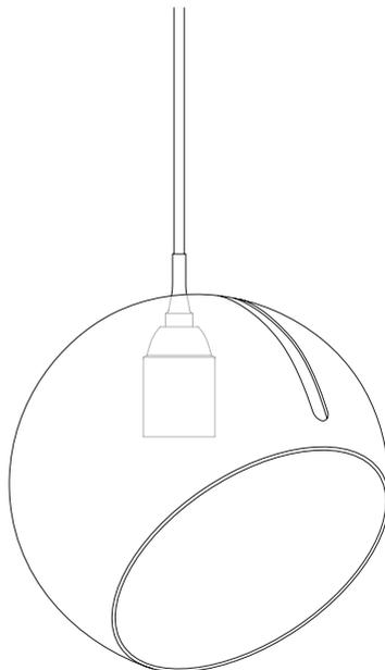
Ziehen Sie das Kabel vorsichtig von unten durch den Schlitz des Leuchtschirms, bis er auf der Schirmführung aufsitzt.
