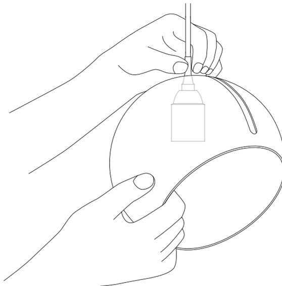
Zum Verstellen des Leuchtschirms verwenden Sie am besten zwei Hände. Mit der einen wird die Schirmführung am Kabel festgehalten, mit der anderen wird der Schirm leicht angehoben und in die gewünschte Position gedreht und geneigt.
