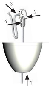
Ziehen Sie das Kabel durch das Loch im Baldachin (1). Befestigen Sie danach das Kabel am Aufhänger – drücken Sie dazu das Kabel im mittleren (2), oberen (3) und unteren (4) Bereich fest in die Aufhänger, wie im Bild gezeigt, damit das Kabel sicher fixiert ist.
