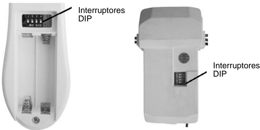
Imagen 11 Compartimiento de las pilas del mando a distancia Conjunto de interruptores DIP del receptor
