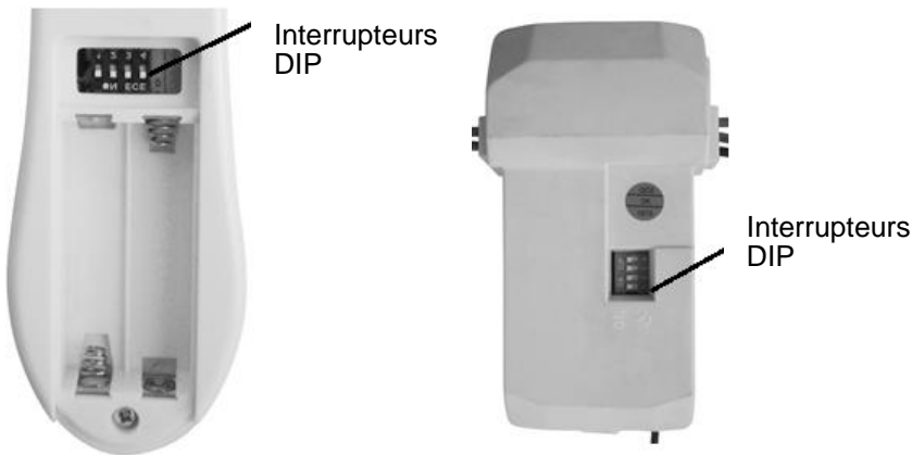
Fig. 11 Compartiment des piles de la télécommande
