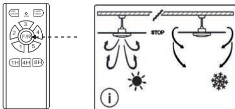
d'air vers le haut déplace l'air chaud stagnant de la région du plafond. Ceci permet de régler le chauffage une température plus faible sans diminution de niveau de confort.
