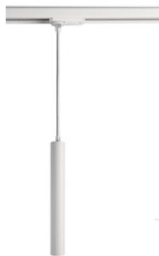
Für das Stromschienensystem gibt es passende Pendelleuchten der SLIM - Serie. Der Leuchtenkörper aus Aluminium-Druckguss ist dabei immer gleich groß [300 x 39mm]. Die Pendelleuchten für die Stromschienen ermöglichen eine Abhängung von maximal 1800 mm.
