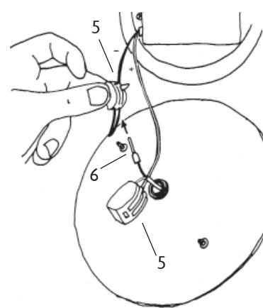
5. Aufputzdose schließen / Closing the ceiling box / Fermer le boîtier sur crépi / Chiudere la scatola di derivazione esterna
