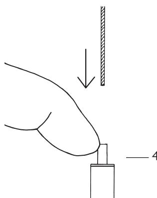
4. Lampenkabel anschließen / Connect lamp cable / Brancher le câble de la lampe / Collegare il cavo della lampada
