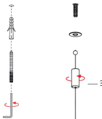
3. Stahlseil einstecken / Insert steel cable/ Insérer un câble en acier / Inserire il cavo d'acciaio
